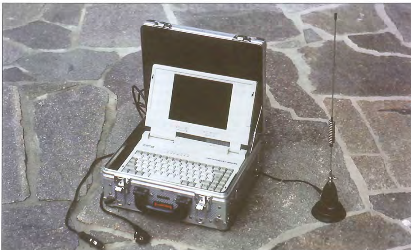
Abb. 13: Mobilstation mit Antenne (Steuerzentrale oder passive Lesestation).
