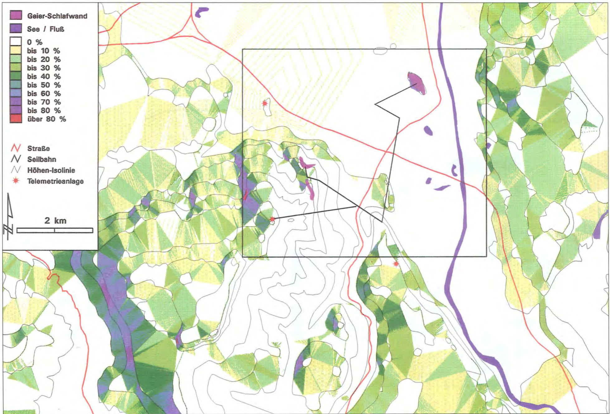
Abb. 38b: Hangaufwind (W-Wind mit 5 m/s) zu Abb. 38a (ausschließlich dynamischer Hindernisaufwind, eingezeichnet ist der Ausschnitt von Abb. 37a mit Flugroute).
